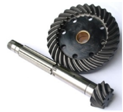
FIGURE 21 : COUPLE CONIQUE, ENGRENAGE DESTINE A TRANSMETTRE UN MOUVEMENT ROTATIF.
