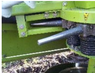
Rotor à doigts souple canalisant les tiges vers l'alimentation de l'ensileuse
