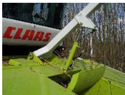
Réglage hydraulique de la hauteur du rabatteur
