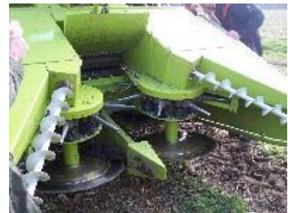
Deux vis latérales aident la canalisation des tiges
