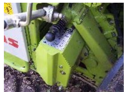
Réglage de la longueur de coupe des brins (17mm)
