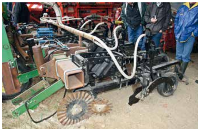
Technique de travail simplifié du sol : strip-till à disques couplé à un élément semeur.
